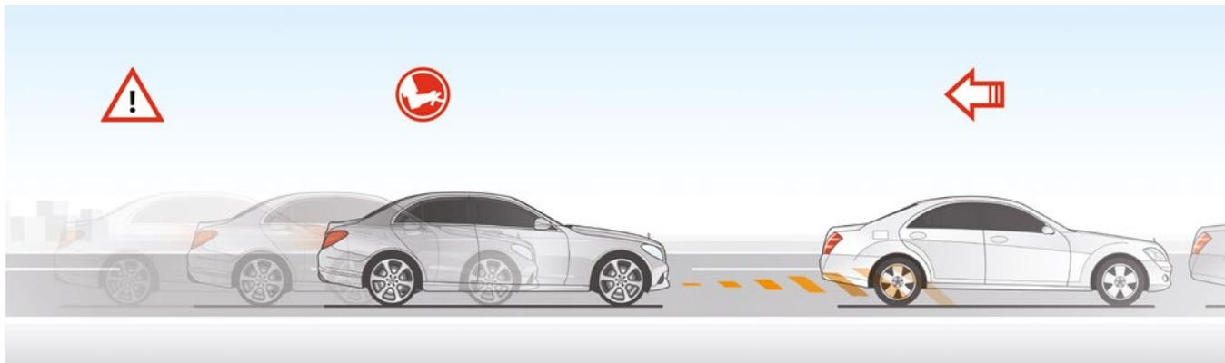
El sistema de alerta por cansancio ATTENTION ASSIST puede aumentar la seguridad, especialmente en trayectos largos y de noche. Este equipo analiza el manejo del volante para detectar síntomas típicos de agotamiento y una falta de atención, y advierte con señales ópticas y acústicas del peligro de microsueños.
